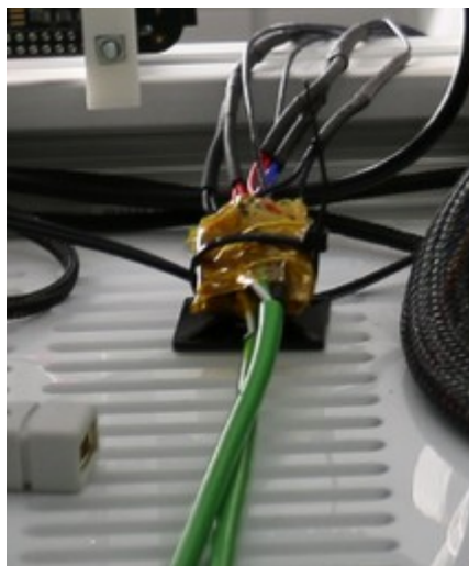
Abb. 3: Die Verteilerplatine sollte gleich zu Beginn auf der Klebeaufnahme mit einem Kabelbinder fest fixiert werden.
