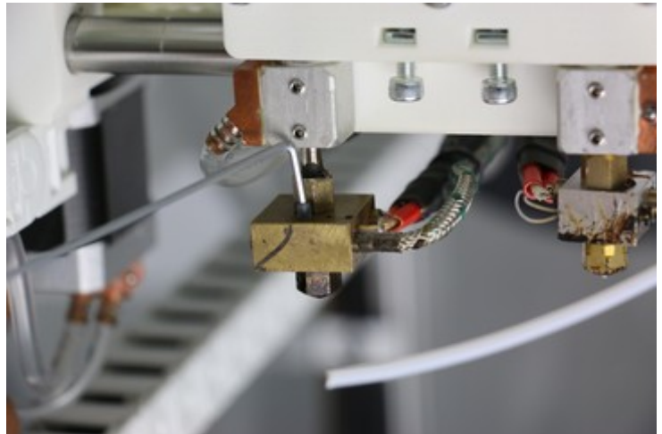
Abb. 6: Das Thermo-Element wird mit der Madenschraube gegen Herausrutschen fixiert.
