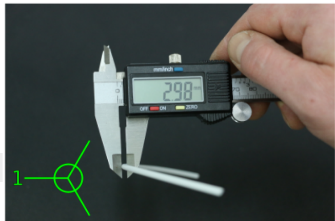
Erster zu messender Durchmesser.
