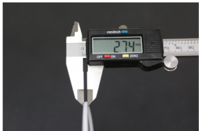
☐ Der gemessene Durchmesser liegt unterhalb der erlaubten Toleranz ...
