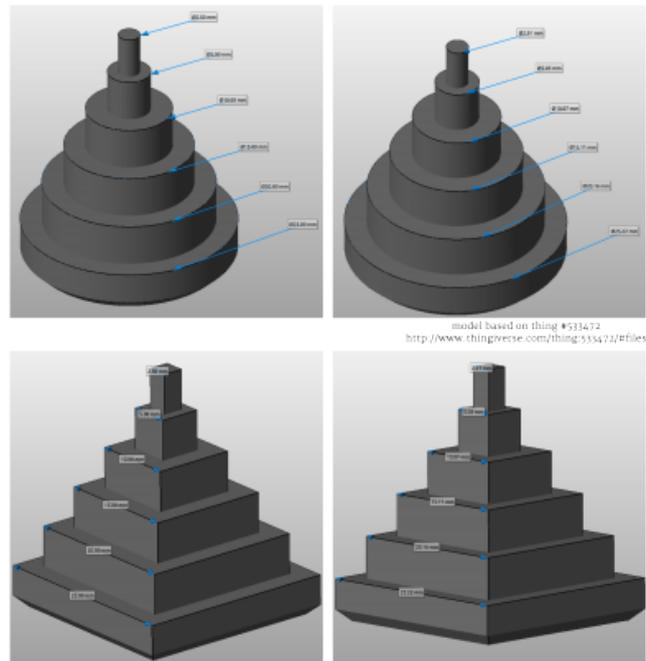
netfabb Visualisierung der ABS Messkörper, die zur Ermittlung der Temperatureinflüsse gedruckt wurden. Links das unkompensierte Grundmodell, rechts das Modell nach Multiplikation mit  $\alpha_L$  vor
