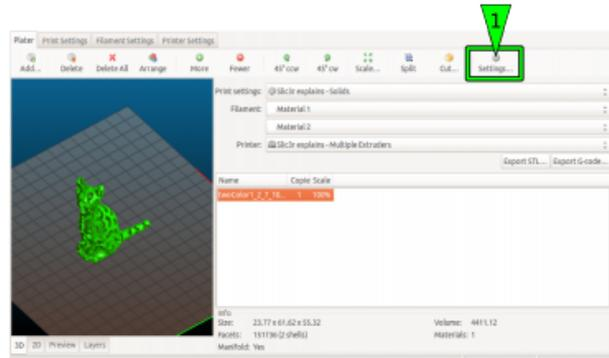
Das erste Modellelement wird wie üblich direkt über den *Plater* hinzugefügt.
