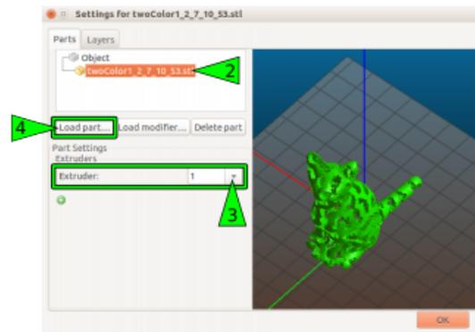
Nach dem Zuordnen der Düse für das erste Modellelement wird der nächste Modellteil über den *Settings* Dialog hinzugefügt.
