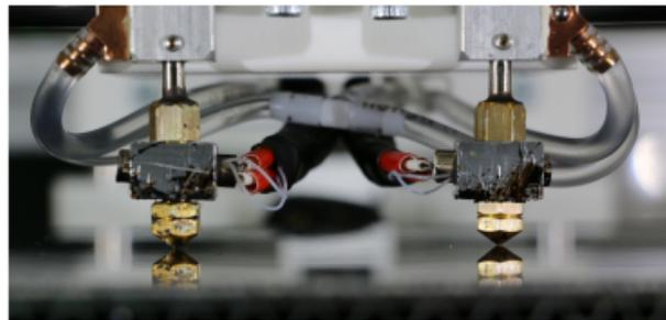
Ein präzises Einstellen der Höhe beider Hot Ends ist die Grundvoraussetzung für Dualdrucke.
