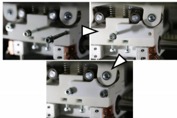
☞ Installieren des Adapters für flexible Filamente.
