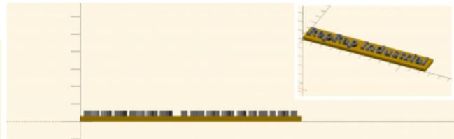
Vorbereitung des 3D-Modells für zweifarbige Drucke; Beispiel 2: zwei einzelne Teile eines Modells in einer gemeinsamen Baugruppe eingefügt, so dass die korrekte Relativposition beim Export als getrennt STL-Dateien übernommen werden
