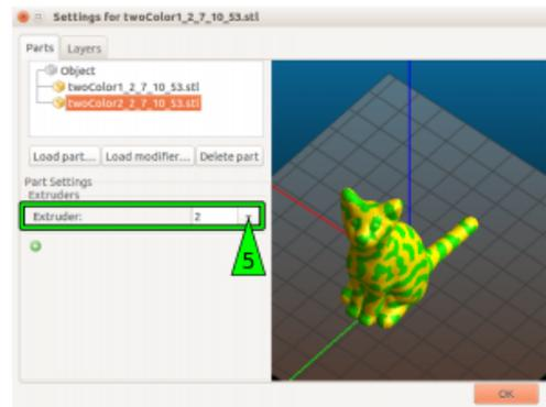
Der zweite Modellteil wird Extruder 2 zugeordnet.
