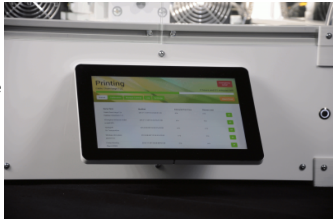
Der hochauflösende 10,-TFT Touchscreen an der Frontverkleidung erlaubt dem Benutzer die direkte Bedienung des RepRap Industrial.
