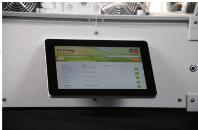
Der hochauflösende 10,1"-TFT Touchscreen an der Frontverkleidung erlaubt dem Benutzer die direkte Bedienung des RepRap Industrial.
