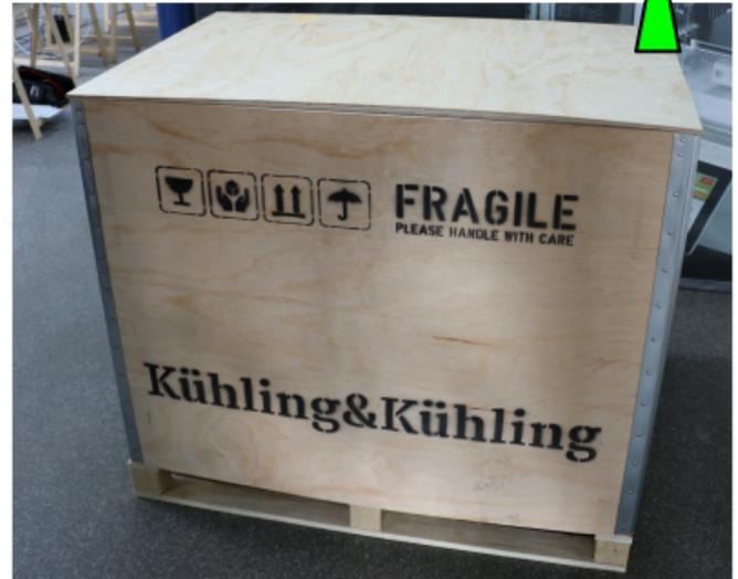
☞ Sicherstellen, dass der Deckel gut sitzt, damit die Verzurrung richtig gespannt werden kann.
