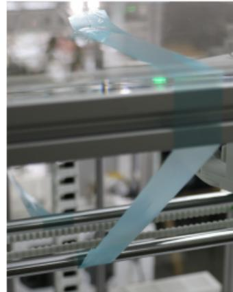
Die vordere Welle der H-Brücke wird an der oberen Abdeckung gegen Rückwärtsrutschen fixiert.
