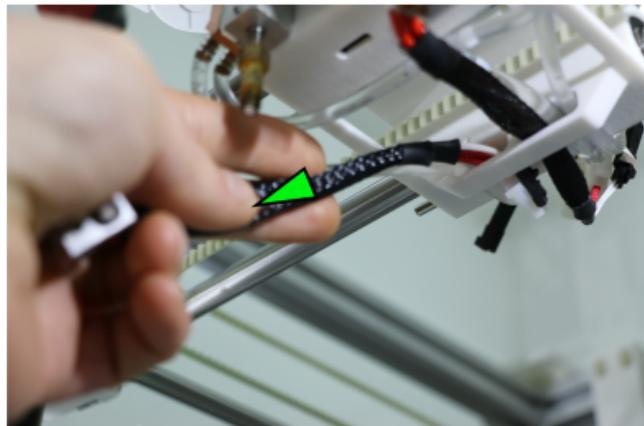
Die Kabel durch die Halterung am Druckkopf ziehen, um den Heizblock abzunehmen.
