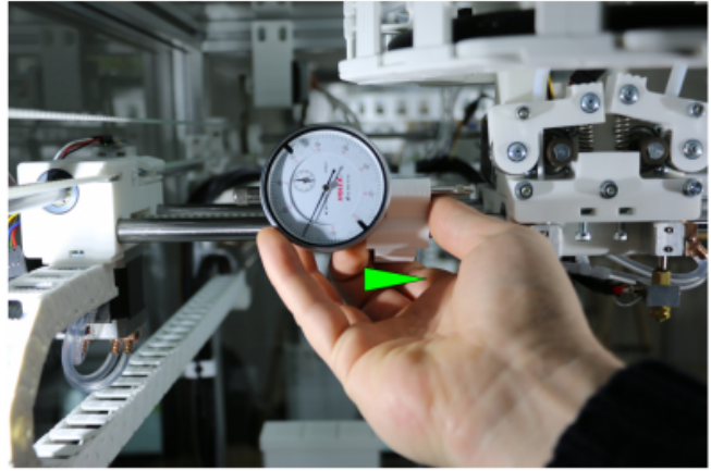
Installieren der Messuhr an der X-Achse.
