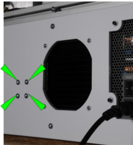
☞ Befestigungsschrauben der Kühlmittelpumpe auf der Rückseite.
