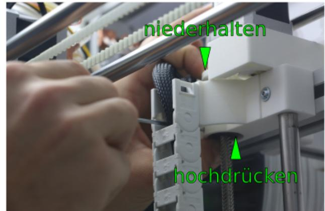
☞ Das Z-Pulley muss niedergehalten werden, während der Stellring nachgesetzt und festgezogen wird.
