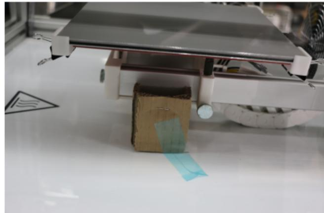
Positionieren Sie die Pappstütze unter dem Drucktisch und fixieren Sie sie mit Klebeband.
