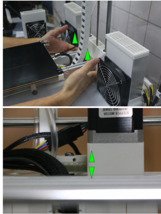
Versuchen Sie, den Z-Schlitten anzuheben und beobachten Sie das Z-Pulley. Bewegt sich das Pulley, muss der Stellring nachgesetzt werden.
