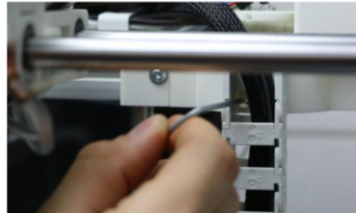
☞ Mit einem Innensechskantschlüssel #2 wird die Spannschraube durch die Zugangsbohrung gelöst.
