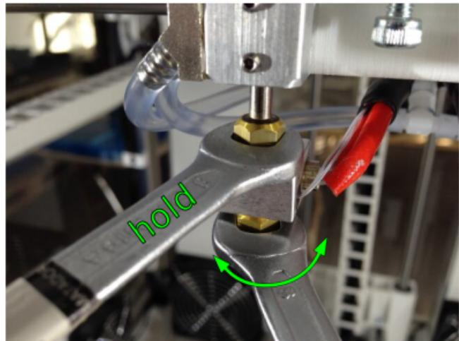
Abschrauben und Wiederbefestigen der Düse erfordern Umsicht, um das Gewinde nicht zu überlasten und abzuscheren.
