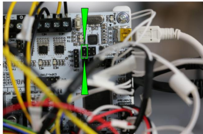
Zu brückende Pins auf dem RUMBA Board, um den USB-to-Serial Chip im Programmiermodus erreichbar zu machen.
