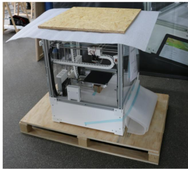
■ Die Deckplatte schützt den 3D-Drucker vor Beschädigungen beim Festzurren.
