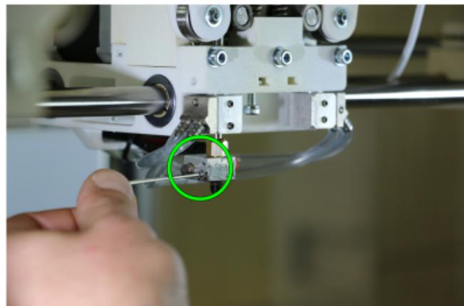
☞ Lösen der Heizblockbefestigungsschraube.
