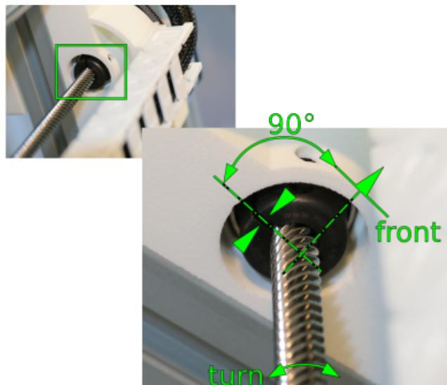
Richten Sie den Kopf der Spannschraube auf die Zugangsbohrung aus.
