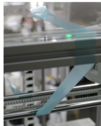
Die vordere Welle der H-Brücke wird an der oberen Abdeckung gegen Rückwärtsschlüpfen fixiert.
