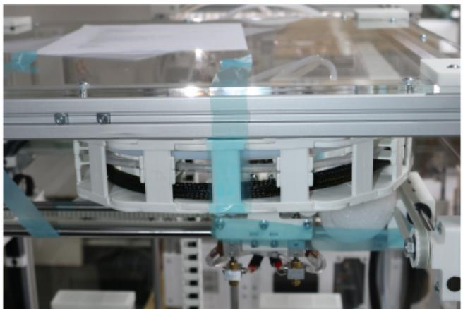
Umwickeln Sie die Energiekette mit Transportklebeband und befestigen Sie sie an der oberen Abdeckung.
