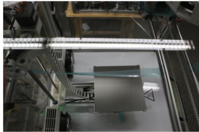
Die hintere Welle der H-Brücke wird gegen eine Z-Welle gegen Vorwärtsrutschen verspannt.
