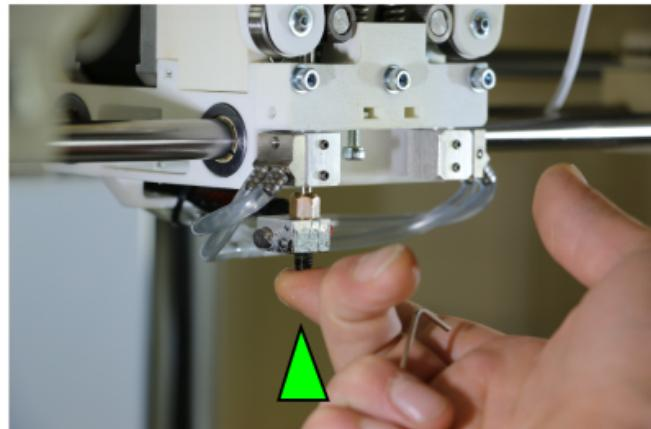
☞ Hochsetzen des Barrels in den Kühlblock und festziehen einer Stellschraube.
