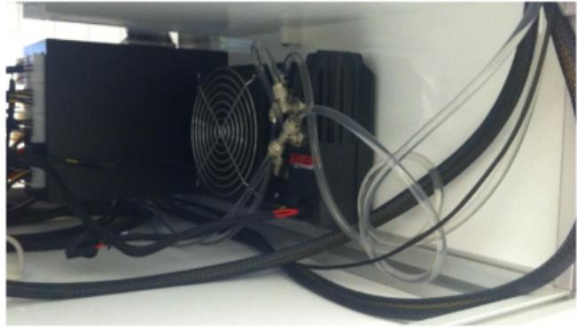
☞ Sitz der Kühlmittelpumpe in der Elektronikkammer.
