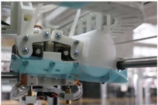
Polstern Sie den Druckkopf mit einer Schaumstoffrolle ab und befestigen Sie ihn mit Transportklebeband stramm gegen X-Wellenschlitten.
