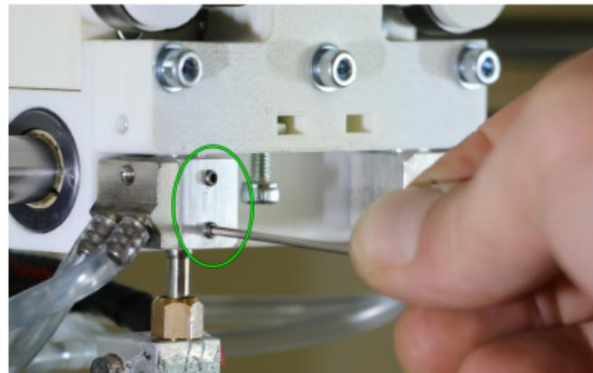
Lösen der Kühlkörperklemmschrauben ist erforderlich, damit die Klebeverbindung von Barrel und Heizblockaufnahme nicht beschädigt wird.
