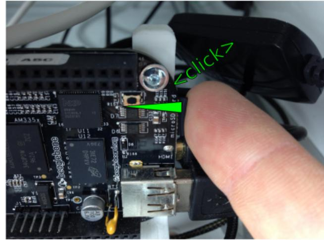
Die SD-Karte entfernen Sie mit der „Push-to-Release“ Funktion.
