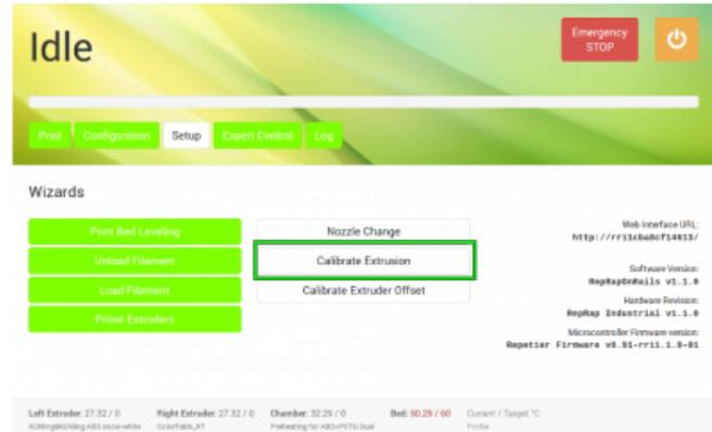
Wählen Sie den [Calibrate Extrusion] Wizard im Setup Menü (alle Software-Versionen).
