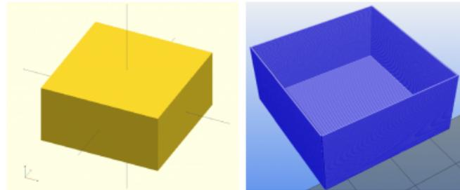
Der 30x30x15mm *Calibration Cube* als OpenSCAD-Modell und mit Slic3r bearbeitet (Ansicht mit Repetier-Host erzeugt).
