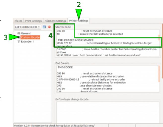
Ändern der Druckkammertemperatur durch Modifikation des individuellen Start G-codes von Slic3r.
