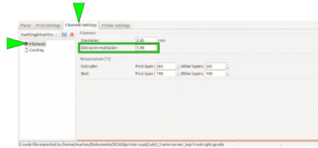
Tragen Sie den Extrusionsmultiplikator in die Filament Settings in Slic3r ein und speichern Sie das Profil (umbenennen nicht vergessen!).
