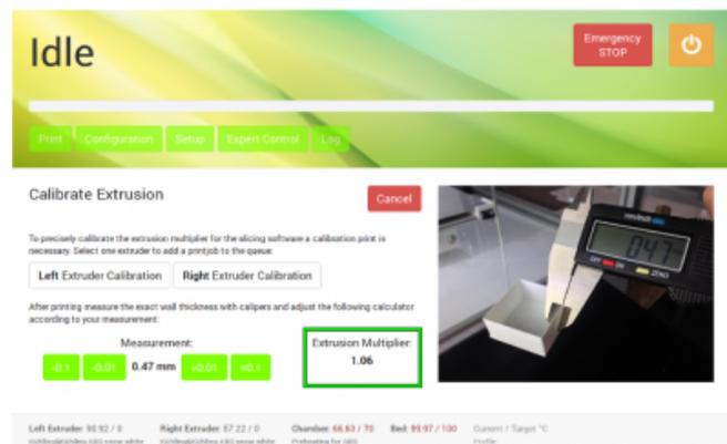
Ändern Sie die vorgegebenen „0,50mm“ über die Schaltflächen auf den ermittelten Durchschnittswert und lesen Sie den Extrusionsmultiplikator direkt am Display ab.
