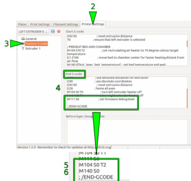
Ausschalten der Druckkammerheizelemente und des Druckbettheizers über den individuellen End G-Code von Slic3r.
