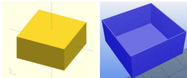
Der 30x30x15mm *Calibration Cube* als OpenSCAD-Modell und mit Slic3r bearbeitet (Ansicht mit Repetier-Host erzeugt).
