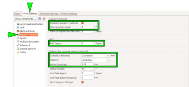
Dargestellt sind die empfohlenen Einstellungen für das Drucken mit löslichem Stützmaterial.
