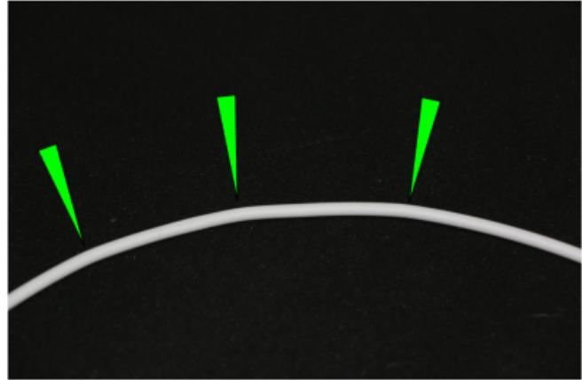
Sichtbare Knicke im Filament können zum Extrusionsabbruch führen.
