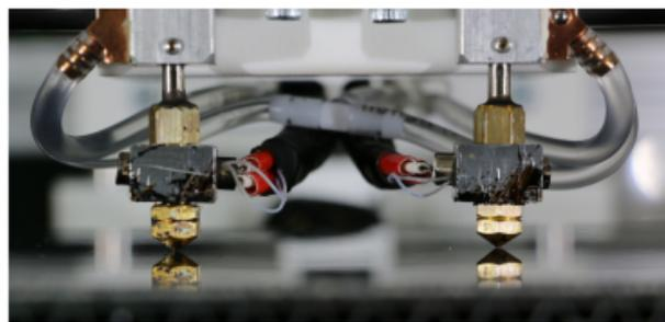
Ein präzises Einstellen der Höhe beider Hot Ends ist die Grundvoraussetzung für Dualdrucke.
