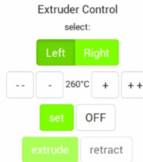
Die optimalen Drucktemperatureinstellungen finden Sie am Besten durch direktes Extrudieren über die Funktionen des *Expert Control* Menüs.
