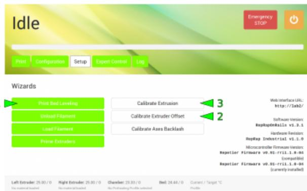
Druckbett- und Offset-Kalibrierung werden über das GUI durchgeführt. Beides ist nur einmal durchgeführt werden, solange die Hardware unverändert bleibt.
