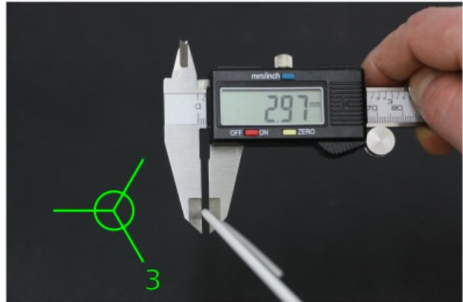
Dritter zu messender Durchmesser – das dargestellte Filament überschreitet die Toleranzen und muss ersetzt werden.
