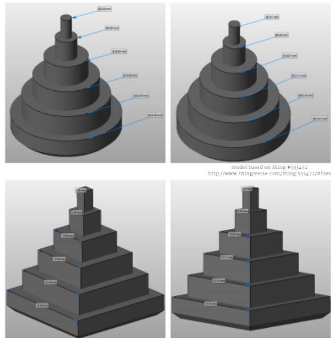
netfabb Visualisierung der ABS Messkörper, die zur Ermittlung der Temperatureinflüsse gedruckt wurden. Links das unkompenzierte Grundmodell, rechts das Modell nach Multiplikation mit  $\alpha_L$  vor
