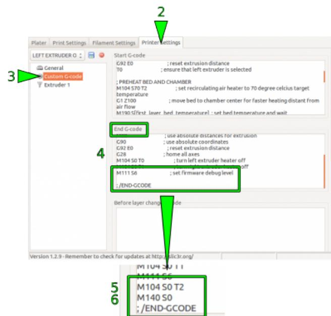
Ausschalten der Druckkammerheizelemente und des Druckbettheizers über den individuellen End
