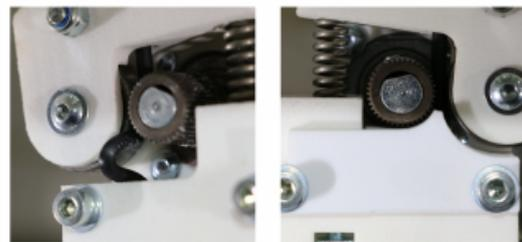
☞ Ohne Adapter verbiegt sich flexibles Filament und weicht aus; mit dem Adapter wird es gleichmäßig extrudiert.
