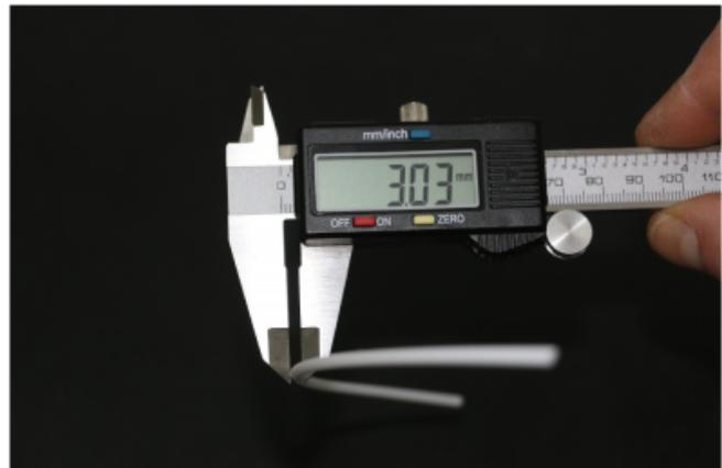
Dieselbe Stelle, um 90° versetzt gemessen. Der Durchmesser überschreitet die zulässige Toleranz – das Filament ist unrund und muss ersetzt werden.
