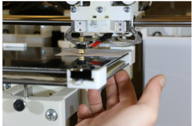
Manuelles Leveln mit Papier als Distanzhalter – vorderer und hinterer rechter Leveling-Punkt.
